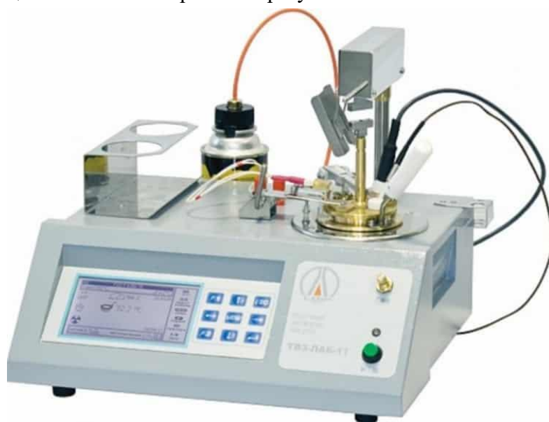
Автоматический прибор ТВЗ-ЛАБ-11 фиксации температуры вспышки
