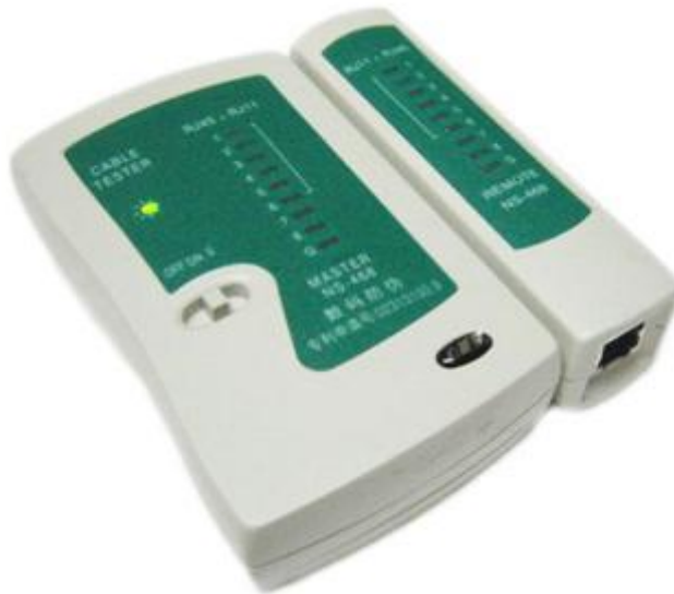
Рисунок 7 - Внешний вид тестера для проверки витых пар RJ-45 модели FA-7012B
