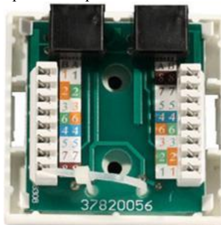
Рисунок 12 - Цветовая маркировка проводов розетки стандарта T568B это: 1 бело-ор, 2 ор, 3 бело-зел, 4 син, 5 бело-син 6 зел 7 бело кор, 8 кор (для варианта T568A цвета тоже нарисованы)
