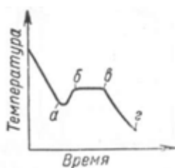
Рис. 13. Кривая охлаждения чистого металла
