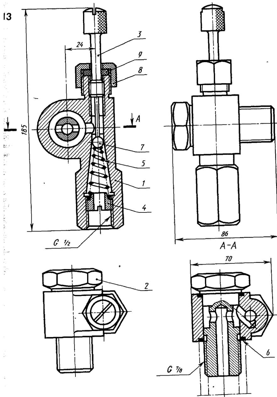
Рис 53 Клапан регулируемый
