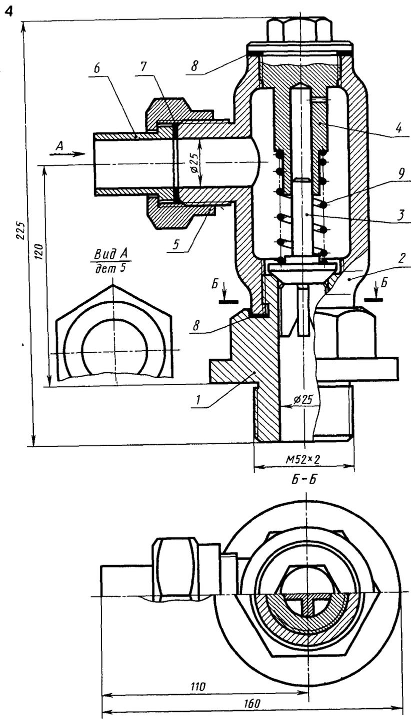
Рис 44 - Клапан обратный
