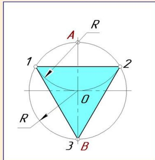
Поставив опорную ножку циркуля в конце диаметра  $A$ , описывают дугу радиусом, равным радиусу  $R$  окружности. Получают первое  $1$  и второе  $2$  деление. Третье  $3$  деление находится на противоположном конце диаметра.
