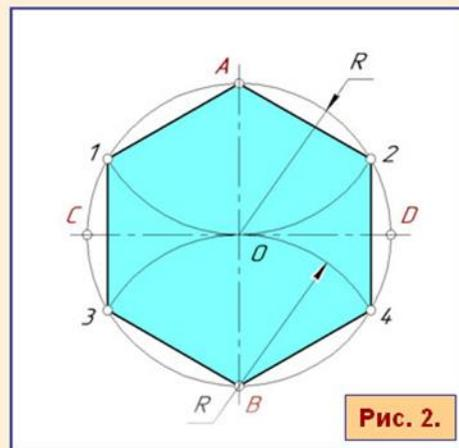
Раствор циркуля устанавливают равным радиусу  $R$  окружности, так как сторона шестиугольника равна радиусу описанной окружности. Из противоположных концов одного из диаметров (например, точек  $A$  и  $B$ , (рис. 1 и 2) описывают дуги. Точки 1, 2, 3, 4, 5, 6 делят окружность на равные части. Соединив их отрезками прямых, получают правильный шестиугольник (рис. 1 и 2).
