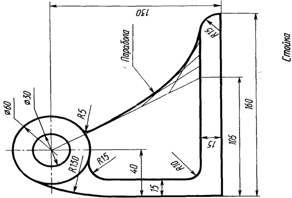
Вычертить по заданным размерам контуры корпуса и стойки. Линии построения лекальной кривой сохранить.
