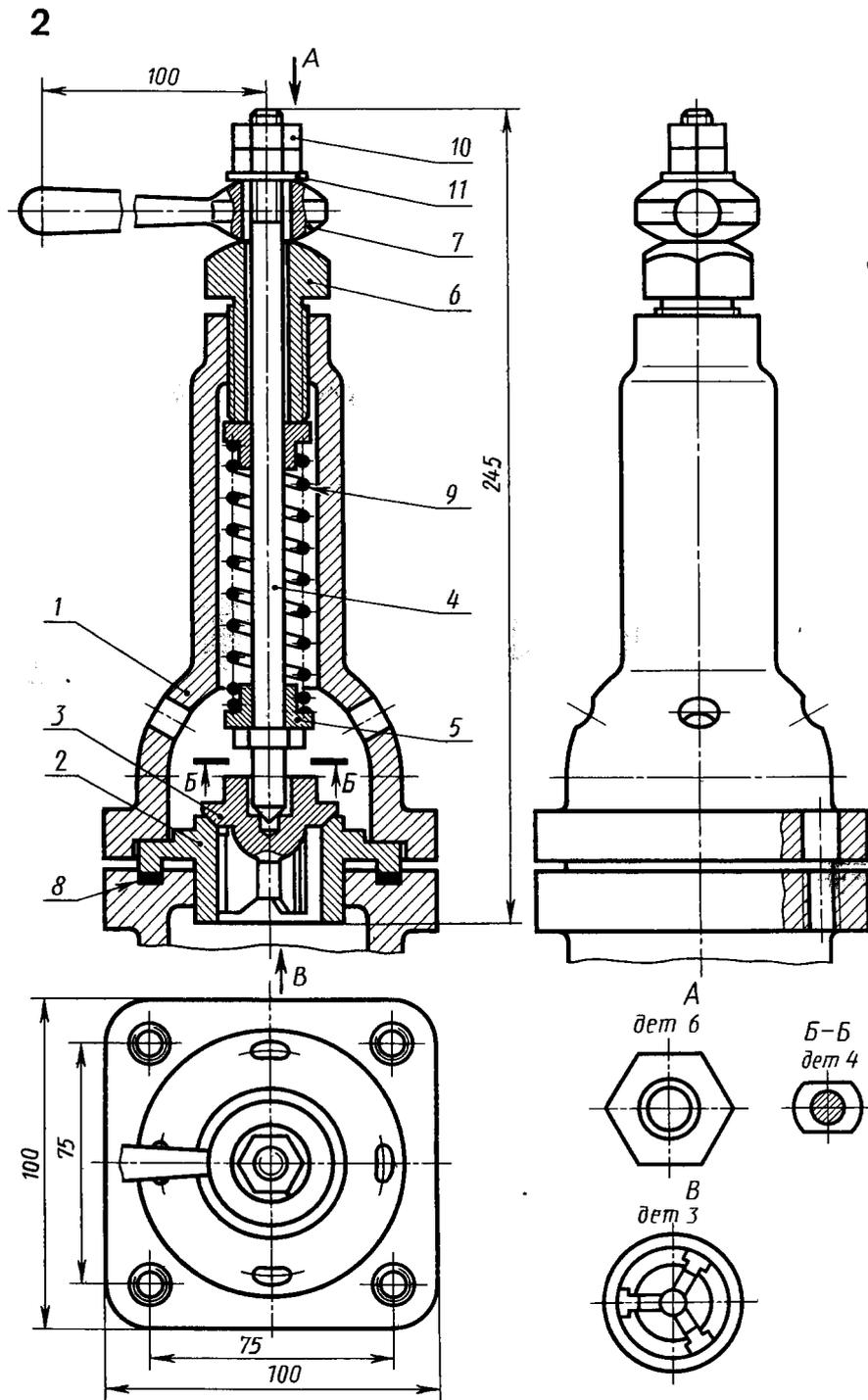
Рис 42 Клапан предохранительный
