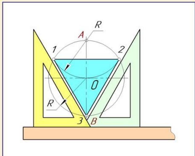
Ту же задачу можно решить с помощью линейки и угольника с углами  $30^\circ$ ,  $60^\circ$  и  $90^\circ$ . Для этого устанавливают угольник большим катетом параллельно вертикальному диаметру  $AB$ . Вдоль гипотенузы из точки  $3$  (конца диаметра) проводят хорду  $1-3$ , получают первое деление. Повернув угольник и проведя вторую хорду  $2-3$ , получают второе деление. Соединяя точки  $1-2$  получают третье деление.
