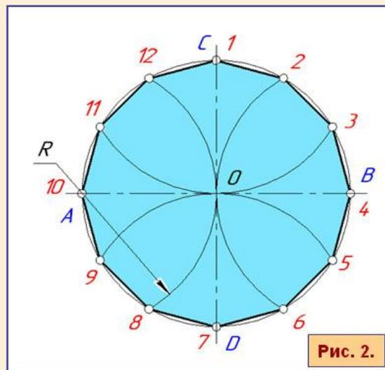
Из противоположных диаметров окружности  $A$ ,  $B$ ,  $C$  и  $D$  описывают дуги. Получим точки 1, 2, 3, 4, 5, 6, 7, 8, 9, 10, 11 и 12. Соединив их отрезками прямых, получают правильный двенадцатиугольник (рис. 1 и 2).
