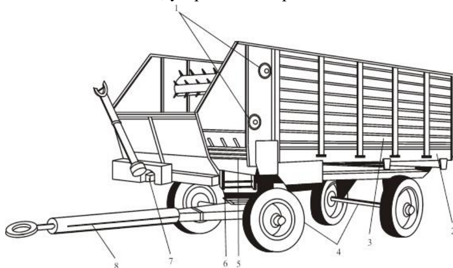
Рис. 1. Кормораздатчик тракторный универсальный КТУ-10А: 1 — блок битеров; 2 — днище (основание кузова); 3 — боковой борт; 4 — ходовая часть; 5, 6 — продольный и поперечный транспортеры; 7 — привод раздатчика с карданом; 8 — спица
