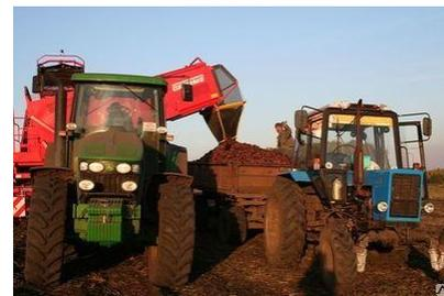
При раздельной уборке картофель выкапывается картофелеуборочными машинами с валкообразователем УКВ-2, который укладывает клубни в валок, в зависимости от урожайности в этот же валок могут быть уложены клубни с двух или четырех соседних рядков. Валки подбираются комбайном ККУ-2 «Дружба», из которого клубни грузятся в транспортные средства.
