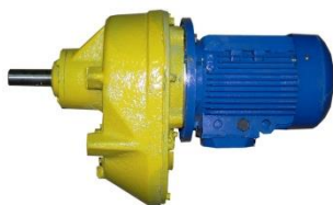
Рис. 3. Приводная станция наклонного транспортера.
