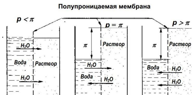
Рис. 1 Схема разделения раствора обратным осмосом
